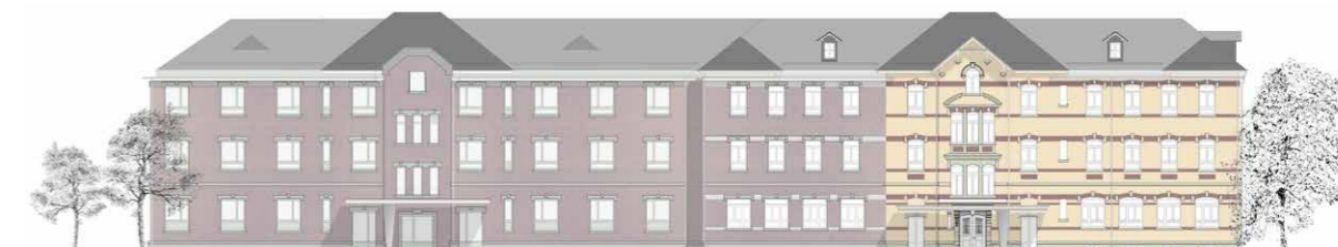
Haus 25 Hoffassade Neubau Ergänzung Bestand Bestand Fassade Haus 25
